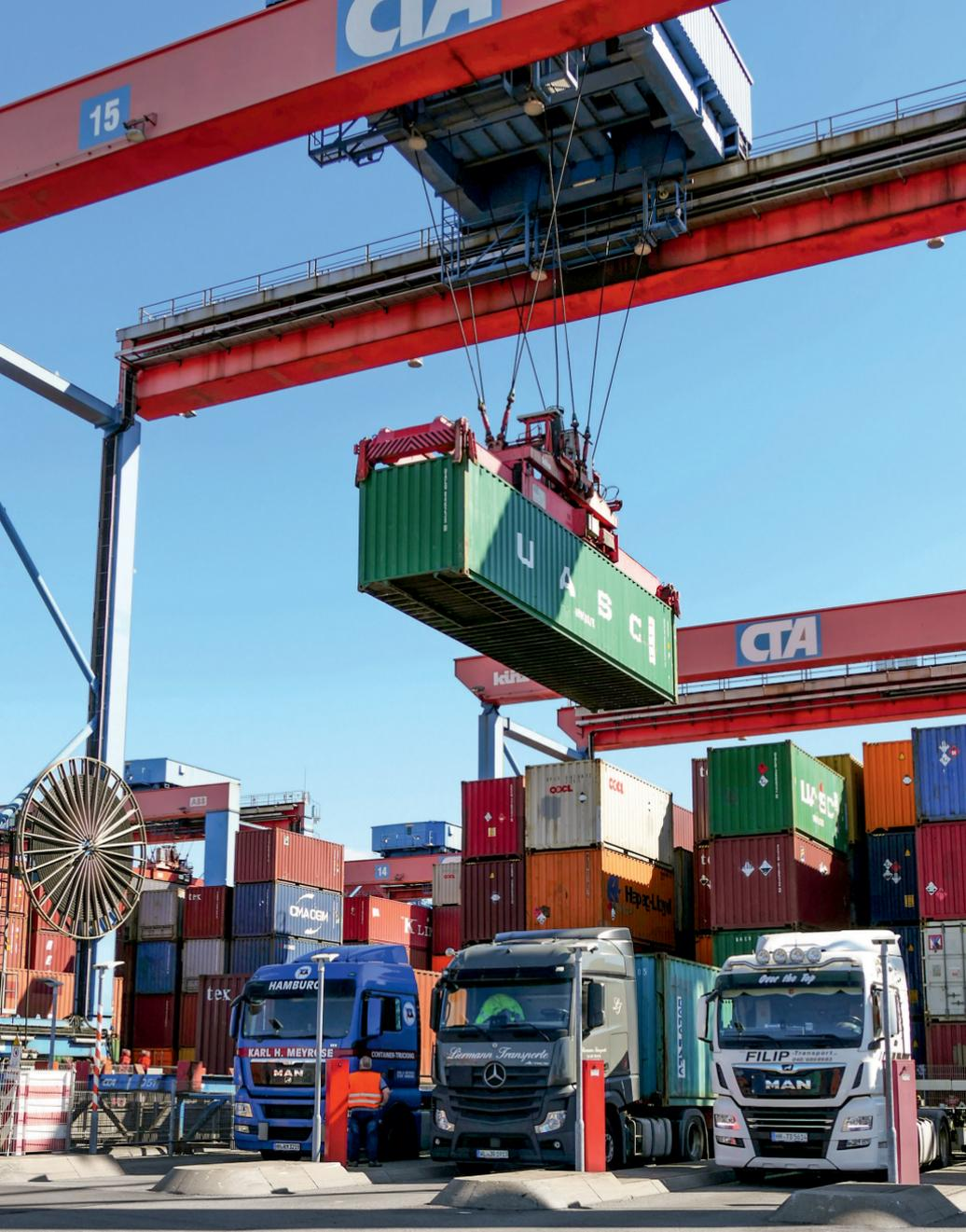
Wird wohl vorerst kein historisches Foto: In Dreierreihen werden die Stahlboxen auf Sattelschlepper verladen, die Containerbrücke am Terminal Altenwerder (siehe Kapitel 65) sucht im sogenannten Blocklager vollautomatisch die richtige Kiste. 24.000 Containereinheiten werden täglich im Hafen umgeschlagen.
